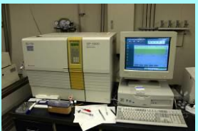
セプタムからガスタイトシリンジで揮発性物質を採集しGC/MS QP5000で分析
